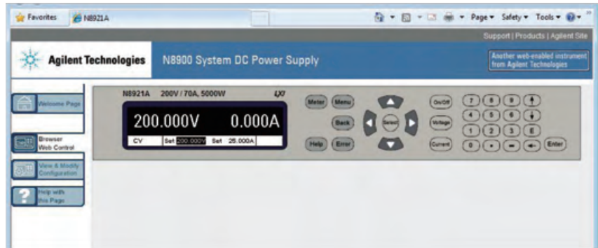
图 3. N8900 系列 web 图形用户界面支持对电源进行远程访问和控制
